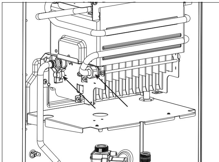
Fig. 28c - Smontaggio bruciatore
