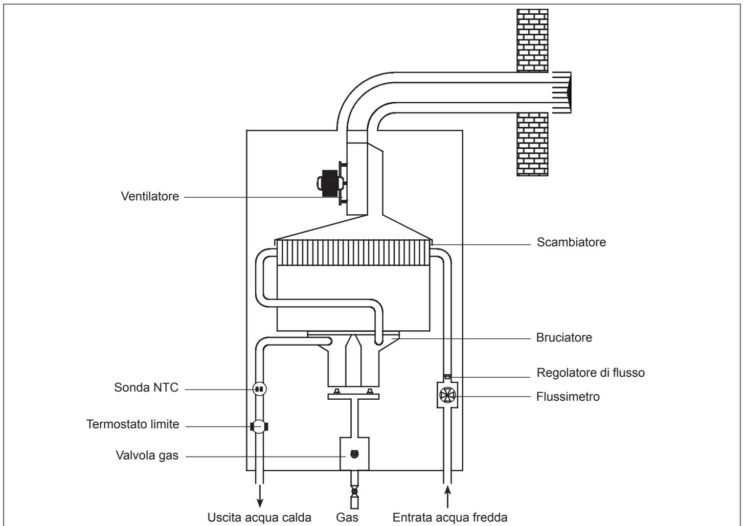
Fig. 6 - Circuito idraulico
