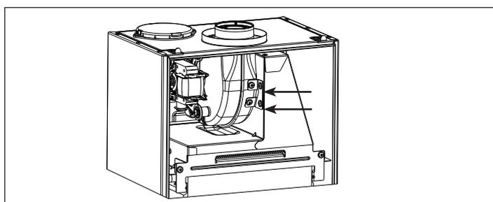
Fig. 27 - Smontaggio ventilatore
