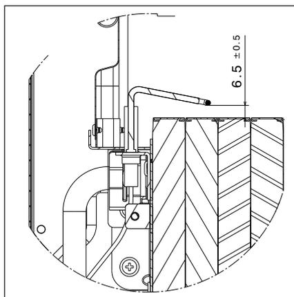
Fig. 2 - Sostituzione dell'elettrodo
