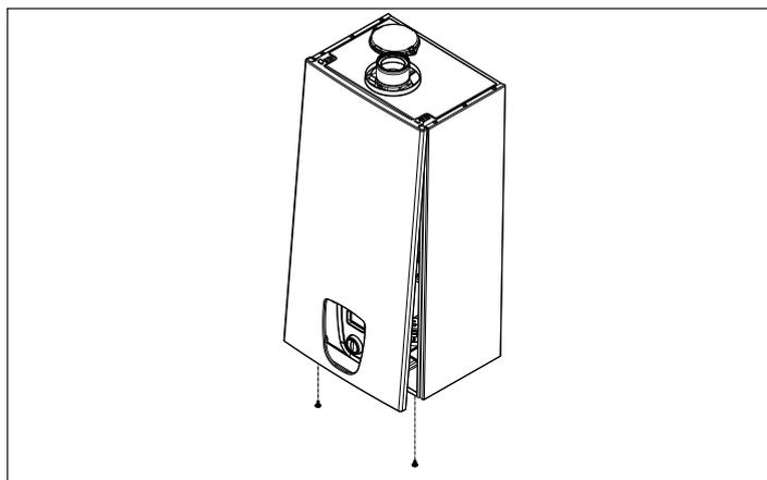
Fig. 24 - Smontaggio del mantello
