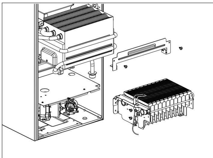
Fig. 29 - Smontaggio scambiatore
