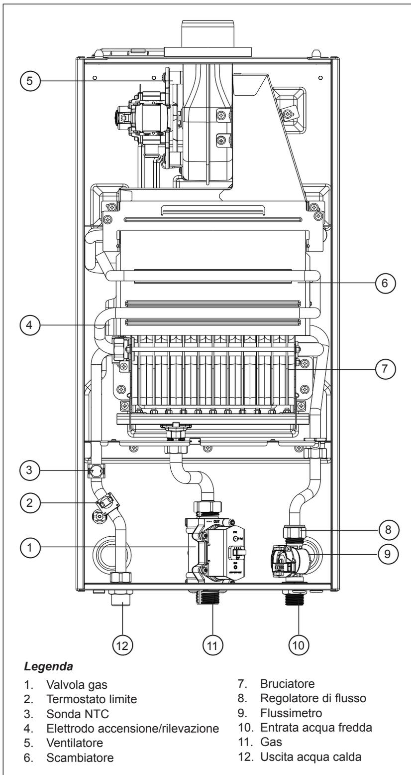
Fig. 1 - Componenti scaldabagno
