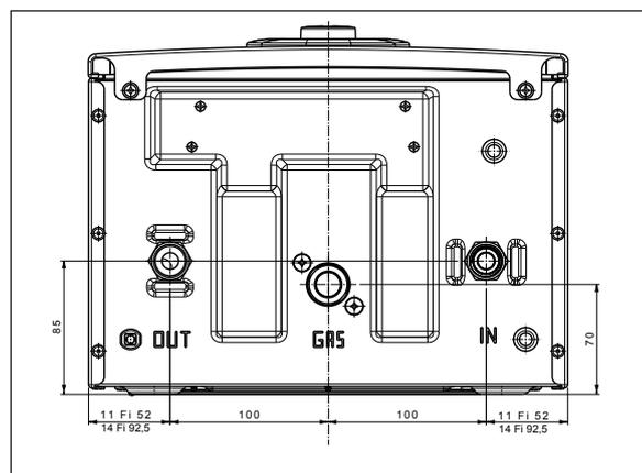
Fig. 4 - Attacchi idraulici
